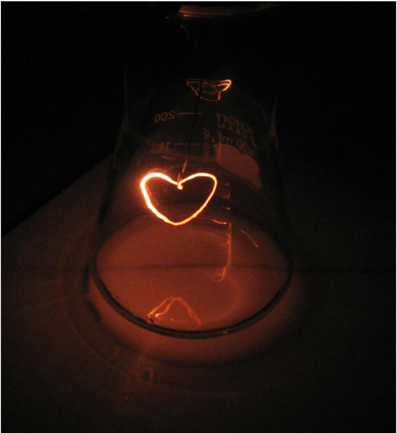
Photo de couverture : Cœur de platine dans la vapeur de méthanol. La décomposition catalytique du méthanol sur le cœur du platine conduit sur une longue durée, à une lueur périodique et une décoloration du cœur de platine.
